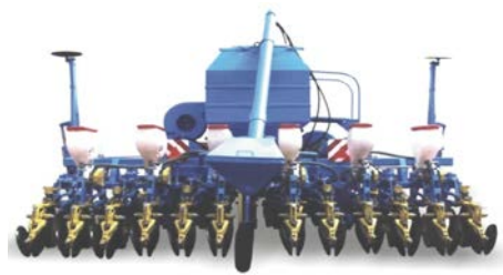
Fig. 3.23. Mașină combinată de lucrat solul și semănat în teren nearat.
